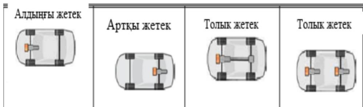
2.3 сурет - Дөңгелектердің қозғалтқышқа жетек біліктері және беріліс қорабы арқылы қосылуы
