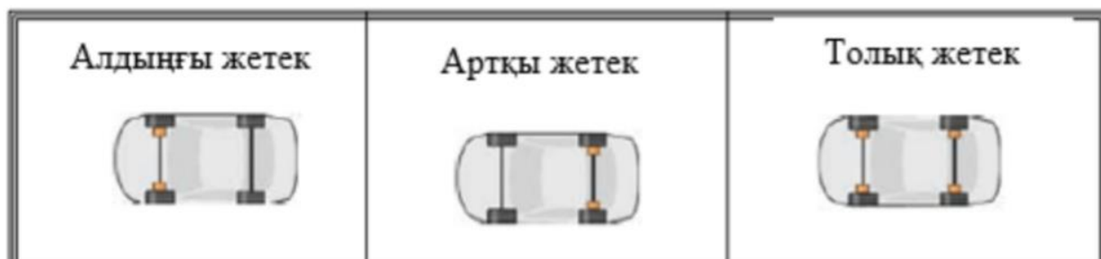
2.2 сурет - Дөңгелектердің қозғалтқышқа тікелей қосылуы
